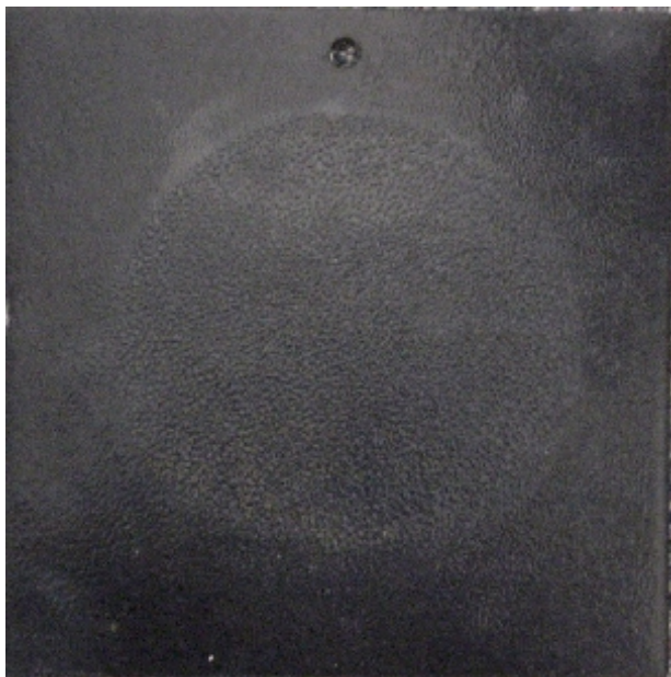
~10 mil pure PFA powder on primer badly blistered
